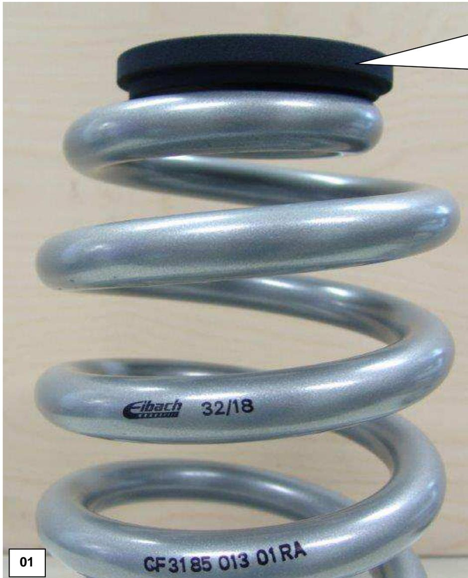
Der Federteller wird oben montiert u. ersetzt die serienmäßige Federunterlage.
