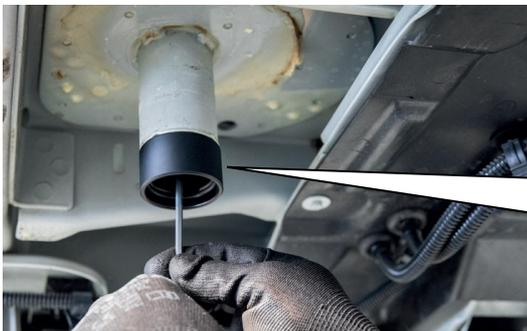
Die Gehäuseverlängerung Anschlagpuffer mit der Imbus-schraube M5 x 40mm verschrauben.
