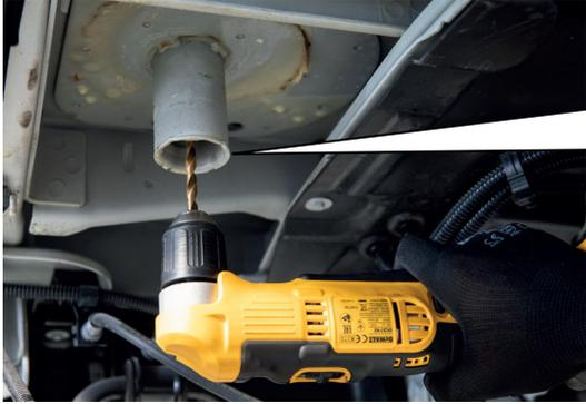
Gummianschlag entnehmen, vorhandene Bohrung auf 7mm aufbohren und Korrosionsschutz auftragen.
