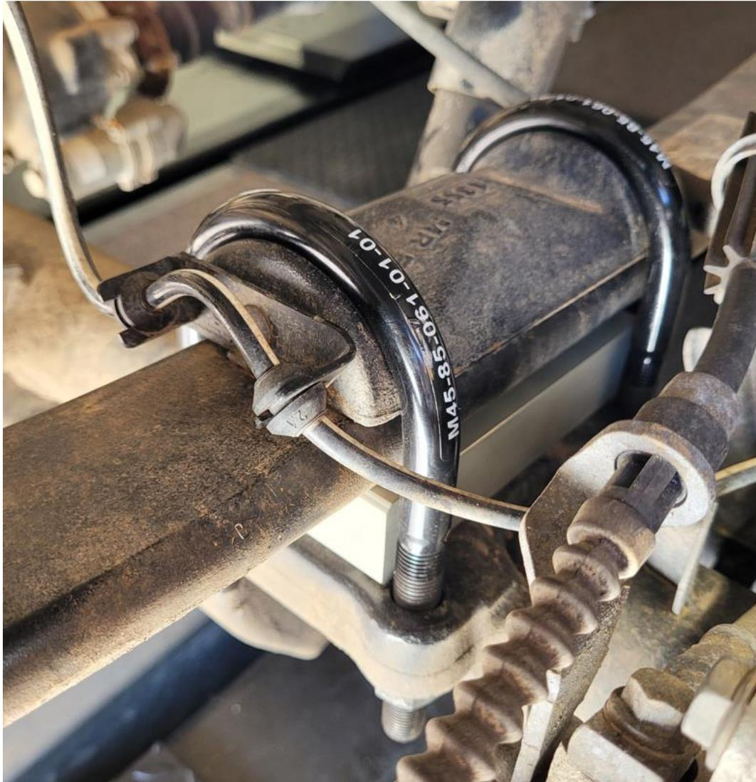
5. Nach Montage des Höherlegungskit sind die demontierten Bauteile wie Stoßdämpfer und Koppelstangen wieder ordnungsgemäß zu befestigen.
