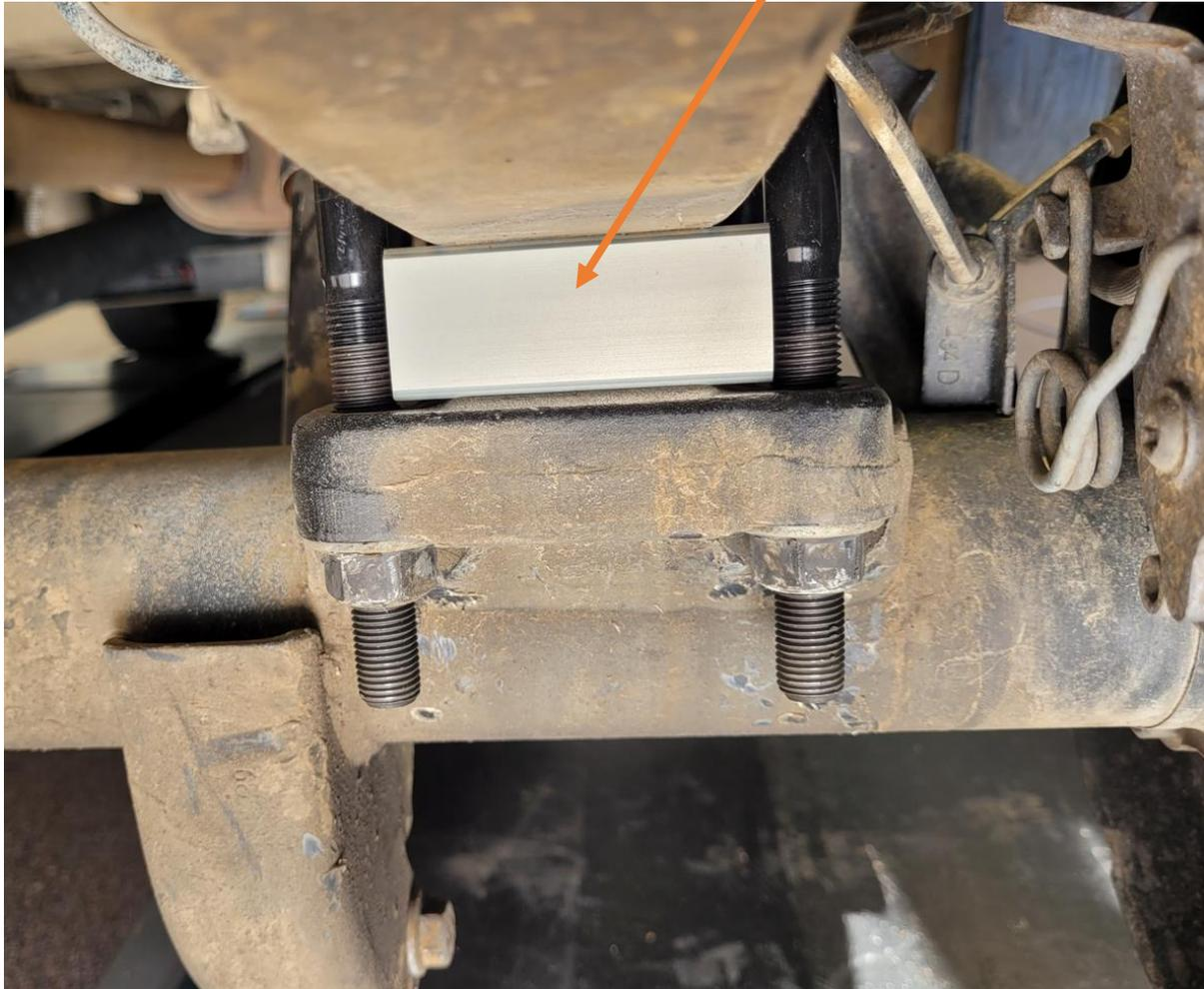
3. Fixieren Sie das Distanzstück (Pos. 02) mit dem original Herzbolzen zwischen Achse und Blattfeder.
